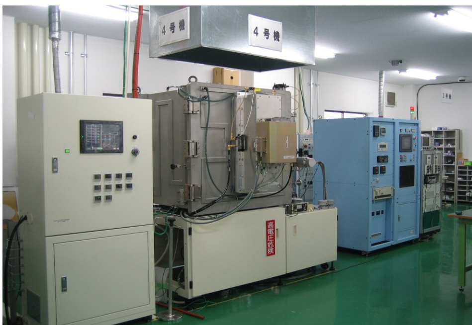
正負パルスイオン源による量産機 チャンバー(1000×1000×1000mm)
