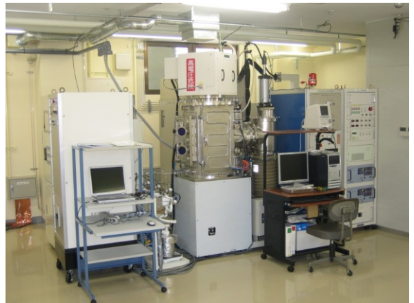
正負パルスイオン源による実験機 チャンバー(600×500×400mm)
