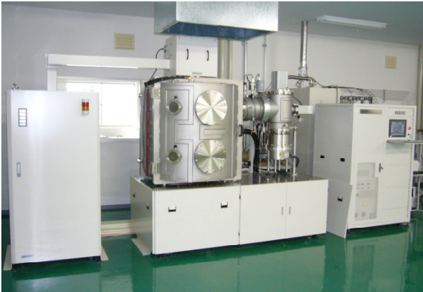
生産機 チャンバー(両面半円扉) 開口幅 900mm 高さ 1000mm 奥行き \phi 1000mm
